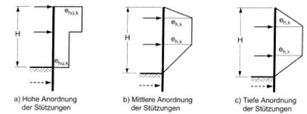
Bild EB 69-3. Lastfiguren für zweimal gestützte Trägerbohlwände
